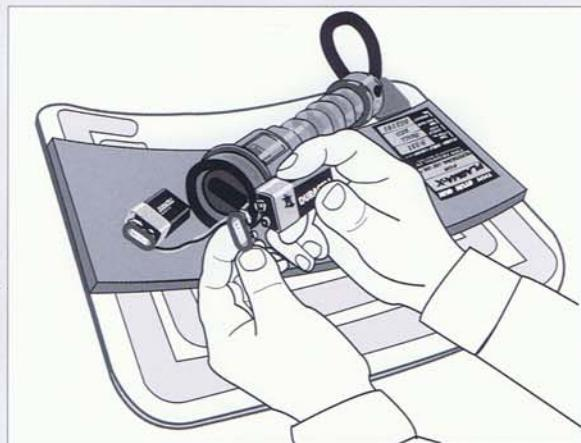
1 把手(グリップ)型スタンガンの電池ボックスのフタを左回り(反時計回り)に開けて9ボルト・アルカリ乾電池を2個ソケットにしっかりと装着します。
