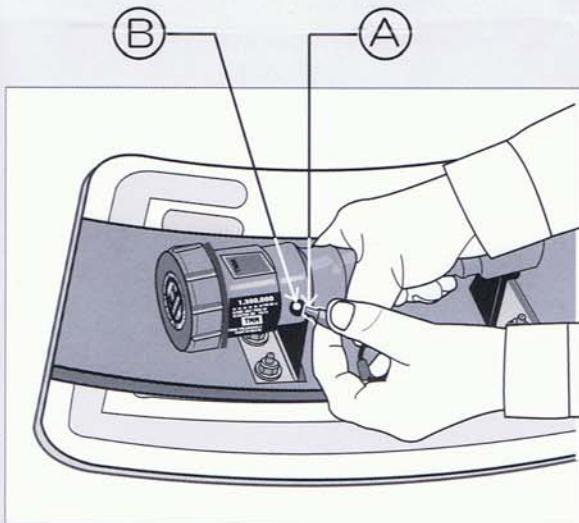
4 ① 安全スイッチを兼ねたストラップを図のように②の専用ソケットに差し込みます。※差し込んでカチッ。と完全に止まるまでしっかりと差し込んでください。
